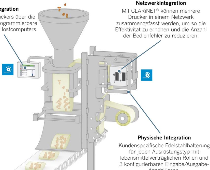
**TTO-Drucker von Videojet integriert in die Vertikal-Schlauchbeutelmaschine eines Maschinenbauers der Fleisch- und Geflügelindustrie.**
